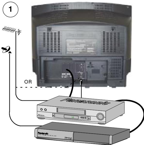
Ligue a antena e o equipamento auxiliar
